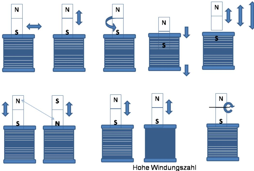
Eine möglichst hohe Spannung in der Spule konnte erreicht werden, wenn...
